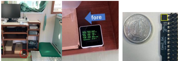
図 4 汐路丸に設置したマイコン端末と MEMS-IMU ” MPU6886” (黄枠内)
