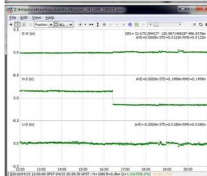
2016/4/15 16:25 GPST 熊本地震 (本震) による電子基準点変位の後処理PPP解析 (RTKLIB 2.4.3 b9, Kinematic-PPP-AR, 暦/FCB: MADOCA最終暦)
