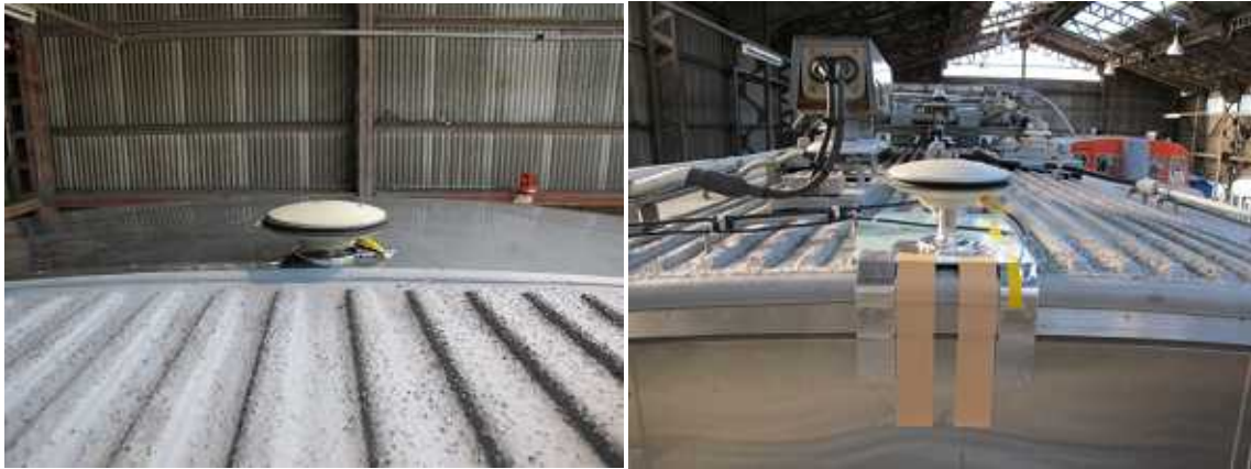
図4 - 1 1 車輻の屋根におけるアンテナ設置状況 左：アンテナ1（車輻前部） 右：アンテナ2（車輻後部）
