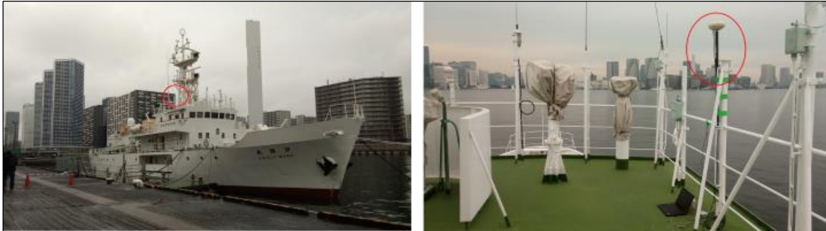
汐路丸上のアンテナ設置位置
