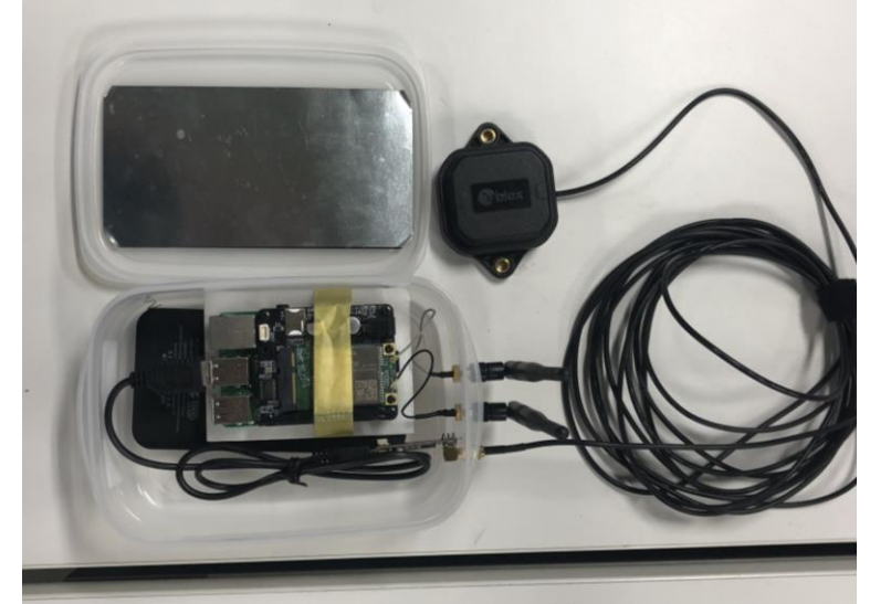
作成したRTK通信キット
