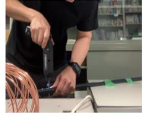
パイプ穴あけ 加工
