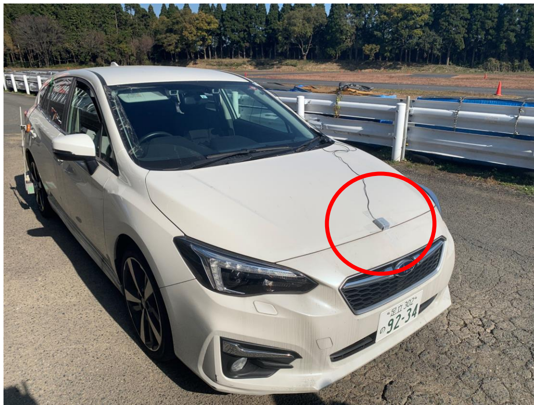
中央：移動側アンテナ ublox社 Multi-band GNSS antenna ANN-MB-00
