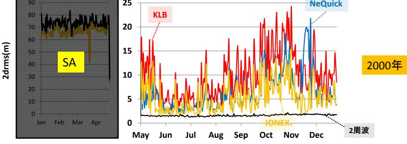
季節の変動により、春と秋の時期に、測位精度が下がり、逆に、夏と冬の時期に、測位精度が上がる。
