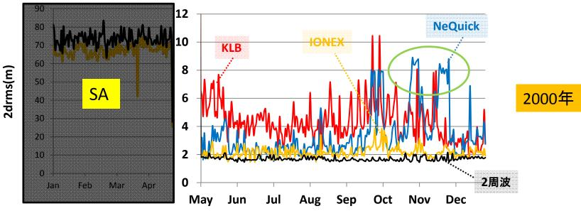
11月前後、Klobucharモデルより、NeQuickモデルの測位精度の方が悪い、 その原因は電離層の突発的な変動の影響を受けたことが考えられる。
