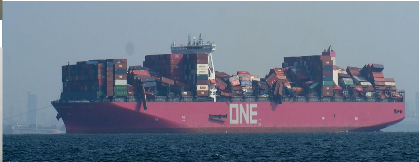
大きな横揺れによるコンテナの流出
