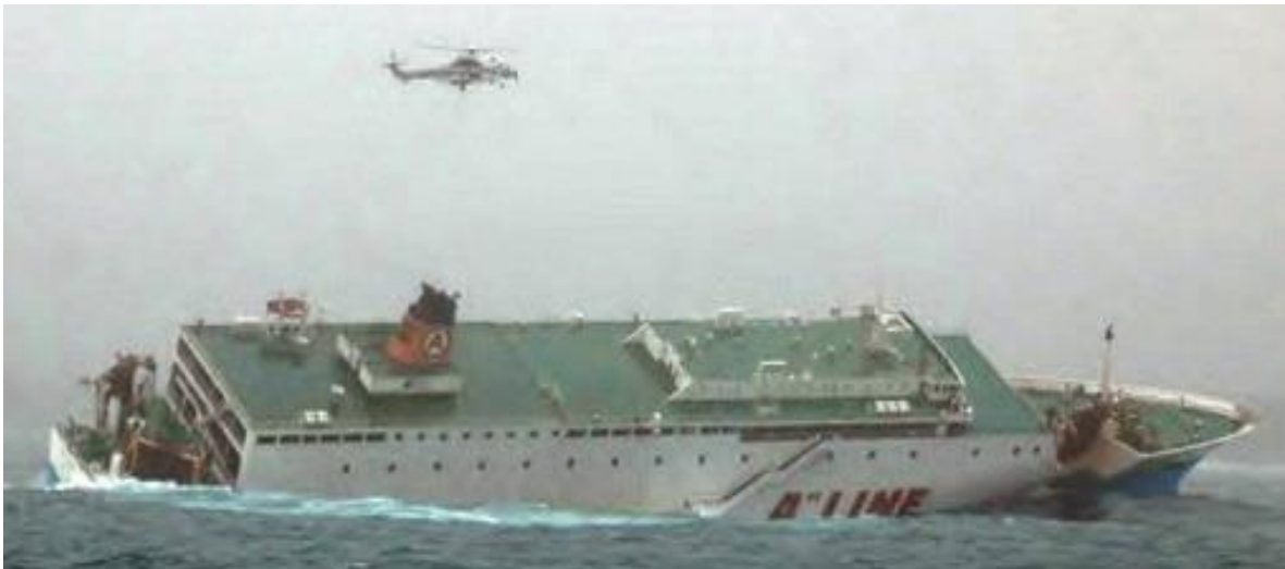
航行中の復原力低下による大傾斜
