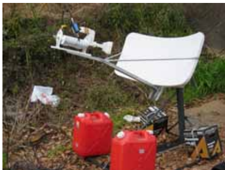
図6 21:VSAT 地球局設置状態
