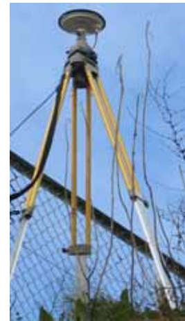
図6 20:アンテナ設置
