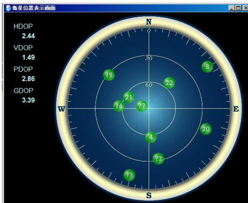
図 53 . GUI ソフトウェア受信機にて天頂の状態を可視化したもの
