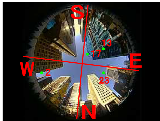
図-4.16 No.4の天空写真と可視衛星の配置 (GPS時刻:361725.8秒 天空率:20.90%)
