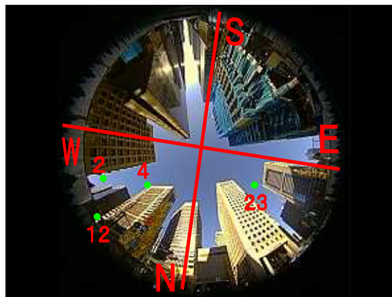
図-4.13 No3-2の天空写真と可視衛星の配置 (GPS時刻:361711.4秒 天空率:17.95%)
