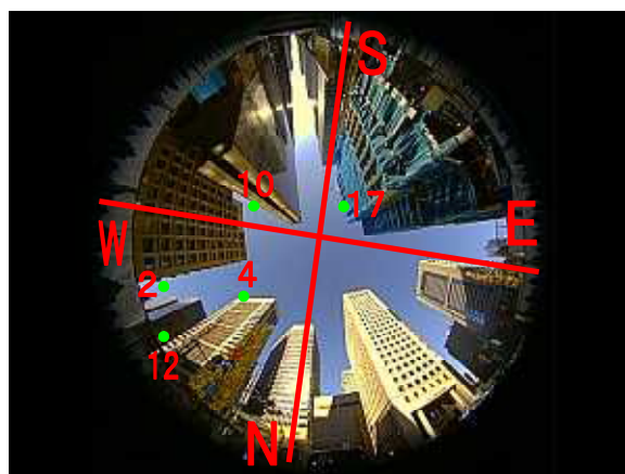
図-4.14 No3-3の天空写真と可視衛星の配置 (GPS時刻:361710.6秒 天空率:15.82%)
