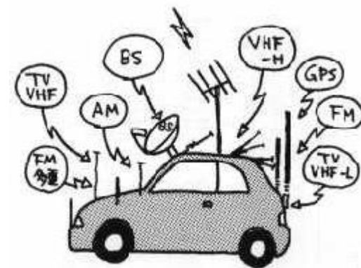
Fig.2 最適化前の車載アンテナの様子
