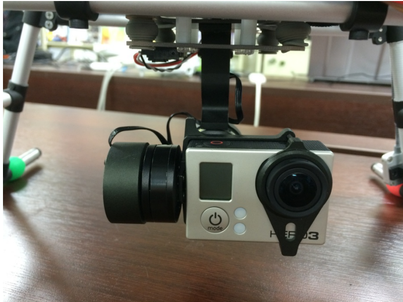
図 2-9 HeiyuTeac 社製 2 軸ジンバルと固定中 GoPro HERO3
