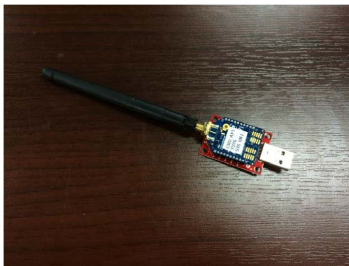
図 2-8 ZigBee 受信機「XBee PRO S2B」(PC 側)
