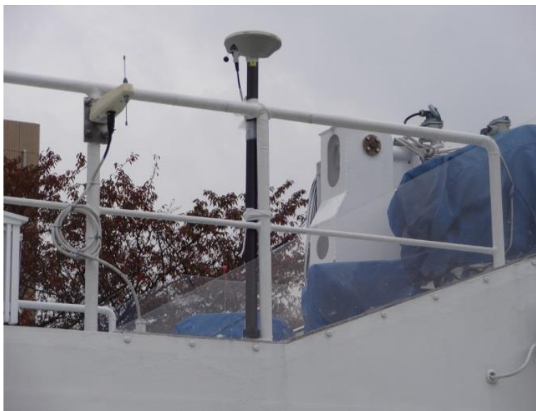
右舷前方に設置したアンテナ
