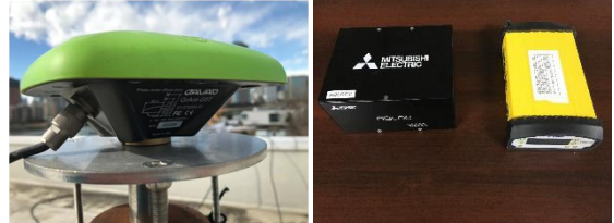
静止点のアンテナと受信機（AQLOC受信機ともう1台の基準となるトリムブル製SPS855受信機）
