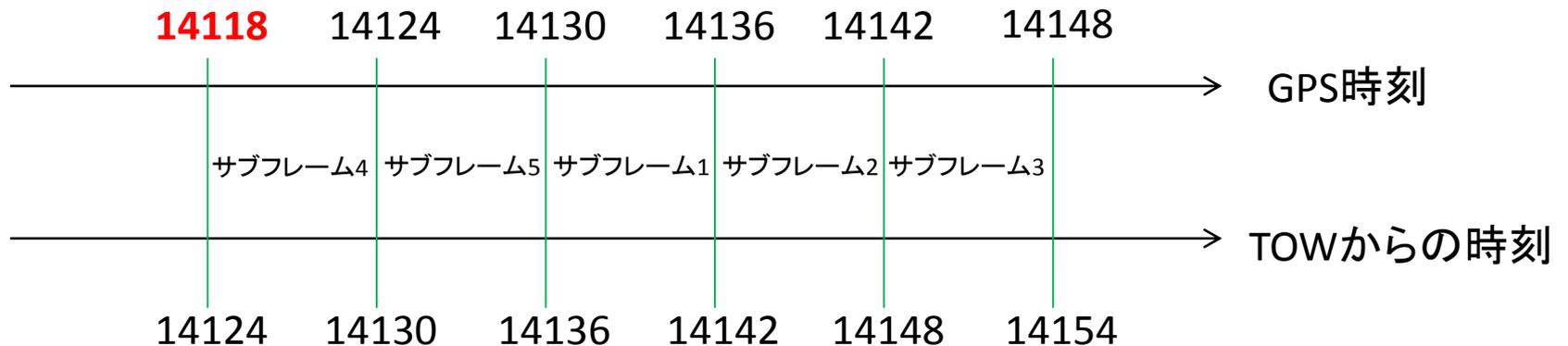
本プログラムではサブフレームを5つ読み終えた時点(サブフレーム3の先頭)でTOW(GPS時刻)を求めているため、30秒引いている!(14148-30=14118)
