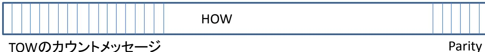
(GPS時刻に変換:**TOWの時刻は次のサブフレームの時刻!**)
